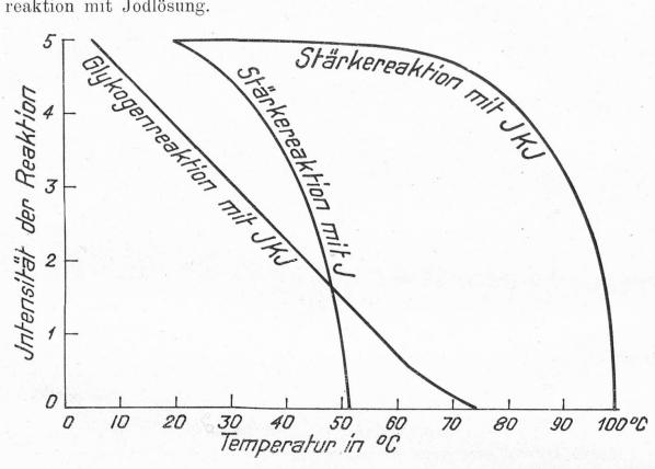
Abb. 3. Der Einfluss der Temperatur auf die Glykogen- und Stärke-Reaktionen mit Jodjodkalium- und mit in Wasser gesättigter Jod-Lösung.
