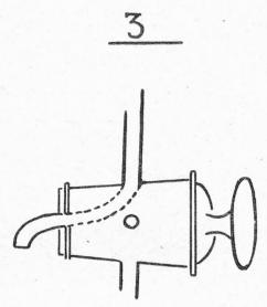
Reinigung des Apparates: Diese erfolgt am besten von Zeit zu Zeit mit konzentrierter Chromschwefelsäure. Ein Ausspühlen mit Alkohol und Aether ist zu vermeiden. Ebenso kann der Kühler in das genannte Säuregemisch eingestellt werden. Durch die Reinigung wird ein flottes Abfliessen des Uebertreibmittels und des Wassers vom Kühler, sowie ein glattes Sammeln im Messrohr erzielt. Auch wird eine gute Trennung der Flüssigkeiten im Messrohr erreicht.
