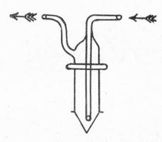
b wird so gestellt, dass das Röhrchen und das Messrohr miteinander verbunden sind. Nun gibt man in das Messrohr soviel vom Uebertreibmittel, dass etwas davon in das Rohr d abfliesst. Der Einhängekühler wird aufgesetzt und der Apparat in einem passenden Stativ befestigt. Es wird mit direkter, freier Flamme erhitzt, die anfänglich ziemlich gross sein darf. Nach einer halben Minute beginnt die Uebertreibflüssigkeit zu sieden und
