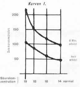
Die Kurven I illustrieren die Verhältnisse besonders deutlich. Sie zeigen, dass wir uns mit der bisher verwendeten Säure 1:1 zu sehr am steilen Ast der Kurve befinden. Kleine, nicht immer vermeidbare Diffe-
