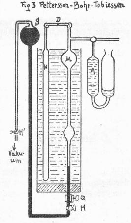
und der Kompensationspipette K; A stellt das Absorptionsgefäss für  $\mathrm{CO}_2$  dar 6). Die Messpipette hat zwei Messbereiche, einen oberen von  $78\,\%$  bis  $81\,\%$  für Sauerstoffbestimmung und einen untern von  $97\,\%$  bis  $100\,\%$  für Kohlensäurebestimmung.
