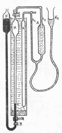
Die Messpipette M steht im gleichen Wasserbad wie die Kompensationspipette K (Fig. 2). Die beiden sind verbunden durch das Absorptionsgefäss A, dessen beide Kapillaren als Manometer funktionieren. Als Sperrflüssigkeit dient Quecksilber.
