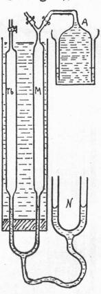
Gas sowohl in der Messpipette, wie auch im Thermobarometer auf den herrschenden Barometerdruck genau einzustellen und dabei gleichzeitig die Volumablesung vorzunehmen und ist dementsprechend zum horizontalen Visieren besonders eingerichtet (siehe Fig. 1).
