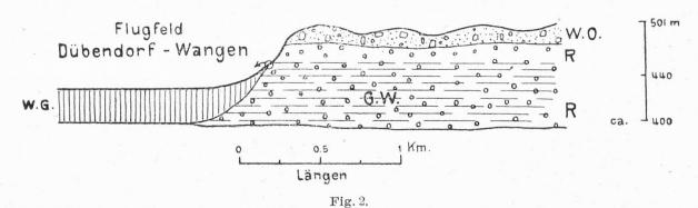
Querschnitt durch ein Grundwasserbecken in der Hochterrasse des mittleren Glattales.
