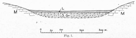
Schematischer Querschnitt durch einen Grundwasserträger mit vollständiger Abdeckung.
