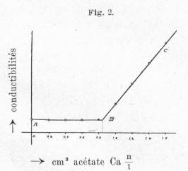
En principe, le dosage par conductibilité s'effectue en ajoutant au vin un excès de tartrate gauche d'ammonium et en titrant l'acide racémique formé par le réactif acétate de calcium  $\frac{n}{1}$ . La courbe de précipitation obtenue est d'une netteté parfaite et permet de fixer le point final de réaction avec une très grande précision. Cependant, on constate que la réaction ne se fait pas suivant l'équation théorique
