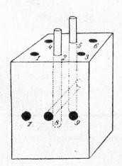
Für die Messung ist ferner ein sogenannter Komparator von Walpole nötig. Dieser lässt sich aus einem kleinen Holzblock leicht anfertigen. Seine Form ist aus nebenstehender Abbildung ersichtlich. Die Löcher 1 bis 6 sind für die Aufnahme der Reagenzgläser bestimmt. Durch die Löcher 7, 8 und 9 blickt man hinein. Hinter diesen Löchern befinden sich (auf der Rückseite) eine blaue und eine Mattscheibe aus Glas.
