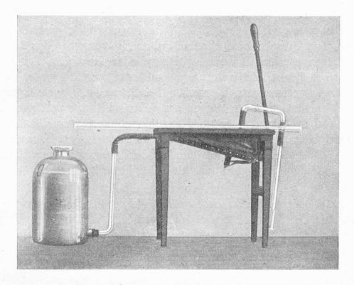
Fig. 1. Apparat zur Jodbestimmung in Luft.
