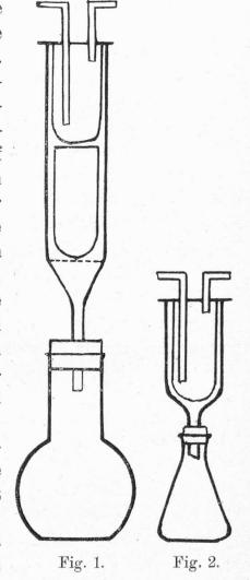
Nach dem von uns gemachten Erfahrungen liefert diese Art der Extraktion genau die gleichen Werte wie die Soxhlet'schen und andere Apparaturen.
