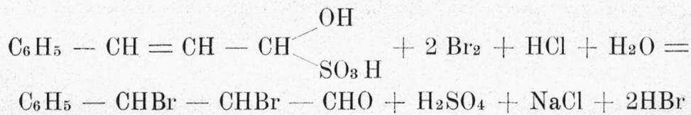
Das Brom oxydiert einerseits die schweflige Säure zu Schwefelsäure, andererseits werden 2 Atome Brom an die doppelte Bindung angelagert. Eine weitere Bromierung, etwa des Benzolkerns, findet nicht statt. 1 Mol. Zimtsäurebisulfitverbindung benötigt somit 4 Atome Brom oder 1 Mol. Zimtaldehyd 2 Atome Brom.
