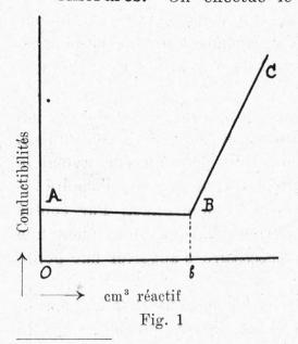
On effectue le dosage physico-chimique des chlorures au moyen du Ag NO<sup>3</sup> N qu'on ajoute au vin par très petites quantités à la fois. On utilise pour cela une petite burette de 1 cm<sup>3</sup>, d'un type spécial 1), permettant d'ajouter le réactif par fractions de quelques centièmes de cm<sup>3</sup>.
