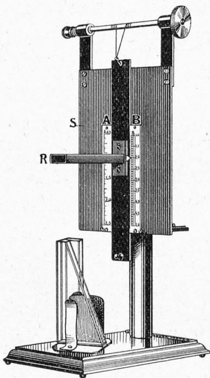
An dem Schirm *S* ist eine Schiebevorrichtung angebracht, welche eine Oeffnung enthält. An diese Oeffnung ist das Sehrohr *R* angeschlossen. Rechts und links von der Schiebevorrichtung befinden sich die Skalen *A* und *B*, hinter dem Schirm sind die beiden Gefäße<sup>1)</sup>, welche die Flüssigkeiten aufnehmen, rechts ein keilförmiges für die Typlösung und links ein parallelepipedisches für die zu untersuchende Lösung. Hinter den Gefässen ist eine Mattscheibe angebracht.
