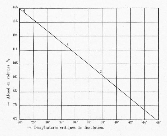
La ligne qui joint les points 1, 2, 3, 4 est une droite parfaite, si les densités et les T C D des diverses solutions ont été déterminées exactement. Pour doser l'alcool dans une solution alcoolique avec une précision égale à celle que fournit la méthode des densités, il suffit maintenant de déterminer la T C D de 10 cm³ de cette solution avec 15 cm³ de la liqueur A et de rechercher sur le graphique la teneur en alcool correspondant à la température observée.
