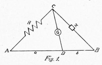
Tritt bei A ein elektrischer Strom in das System, so wird er sich nach zwei Richtungen hin verzweigen; der eine Teil fliesst von A über C, der andere über D nach B. Ist der Punkt C fixiert und mittels eines Galvanometers mit dem auf AB beweglichen Punkt D verbunden, so wird bei einer bestimmten
