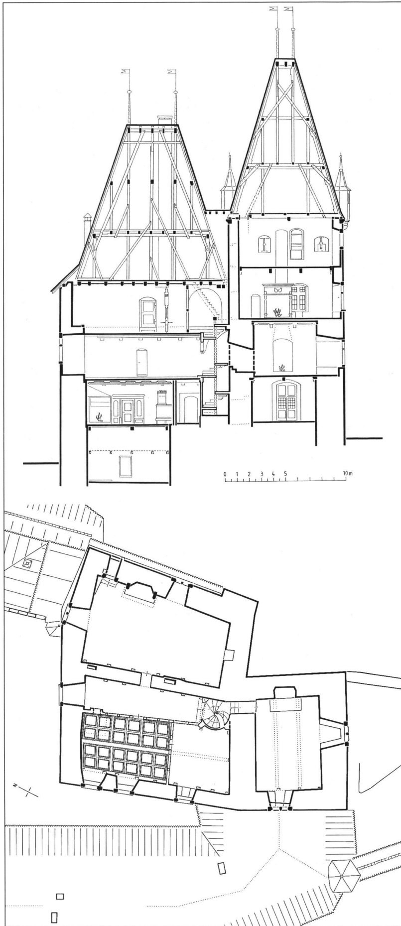
5: Worb, Schloss, Grundriss des zweiten Geschosses von Bergfried und Palas sowie Schnitt N-S durch die beiden Türme, Massstab 1:300.
