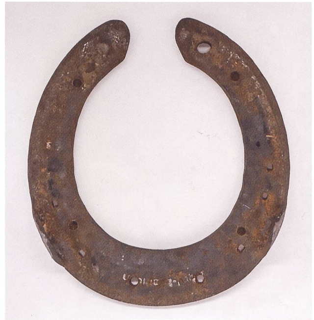
3: Heutiges Fabrikeisen für einen Vorderhuf mit Falz, Stollenlöchern, Löchern für Hartmetallstifte und zwei Kappen. Links: Ansicht der Bodenfläche, Rechts Ansicht der Sohlenfläche.
