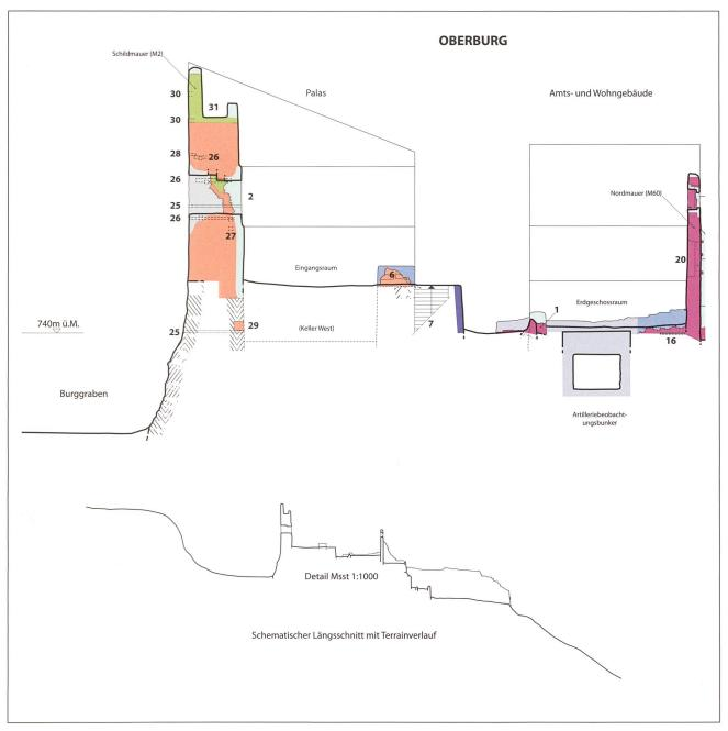
Plan 2: Buus BL, Farnsburg. Nordsüdlich verlaufender Längsschnitt durch die Burganlage mit zusätzlich verkleinertem Profil der Anlage zur Darstellung des weiteren Terrainverlaufs. Blick gegen Nordwesten.
