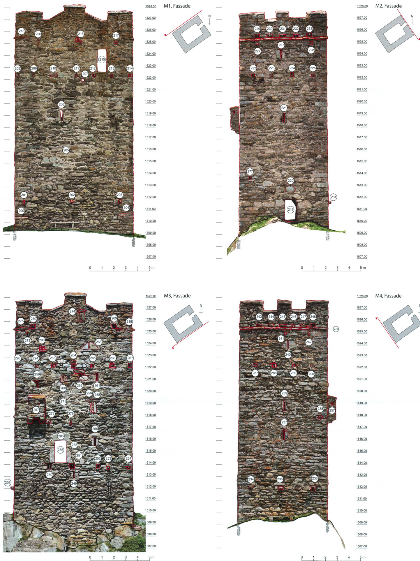
21: Hospital UR, Turm 2021/22. Befundkartierung der vier Innenwände.
