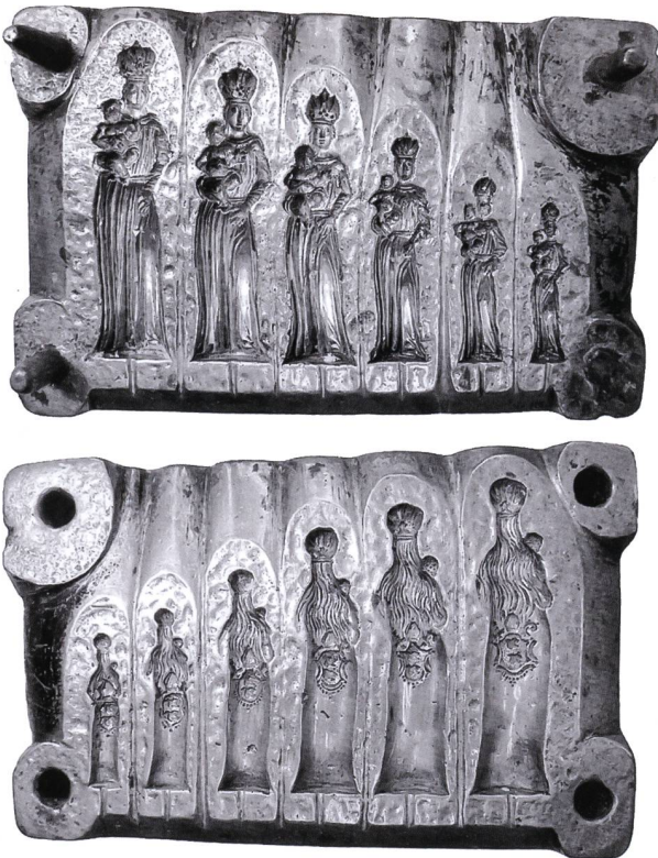
3: Diese Pressform aus der Kunstsammlung des Klosters Einsiedeln ist aus Gusseisen gefertigt.
