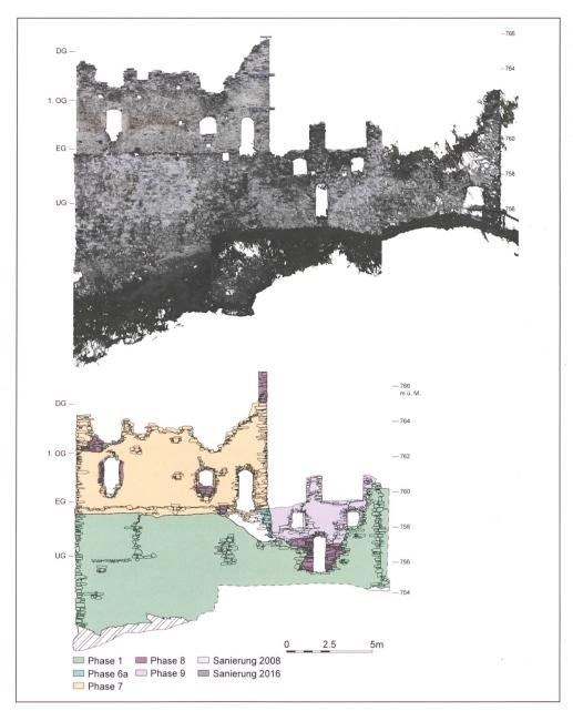
30: Wynegg GR. Sek M5, M3, Westansicht. Orthogonale Ansicht des Nachzustands abgeleitet aus 3D-Punktwolke (Photogrammetrie) und Bauphasenplan basierend auf Kartierung des Vorzustands.
