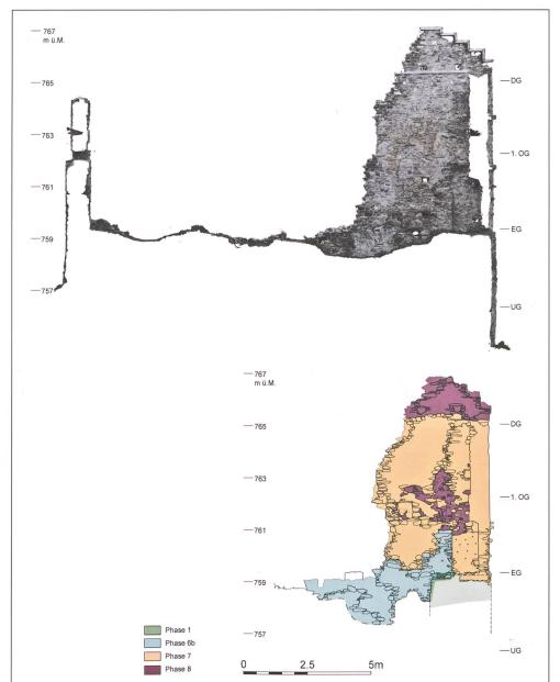
18: Wynegg GR. Sek M4, Südansicht. Orthogonale Ansicht des Nachzustands abgeleitet aus 3D-Punktwolke (Photogrammetrie) und Bauphasenplan basierend auf Kartierung des Vorzustands.
