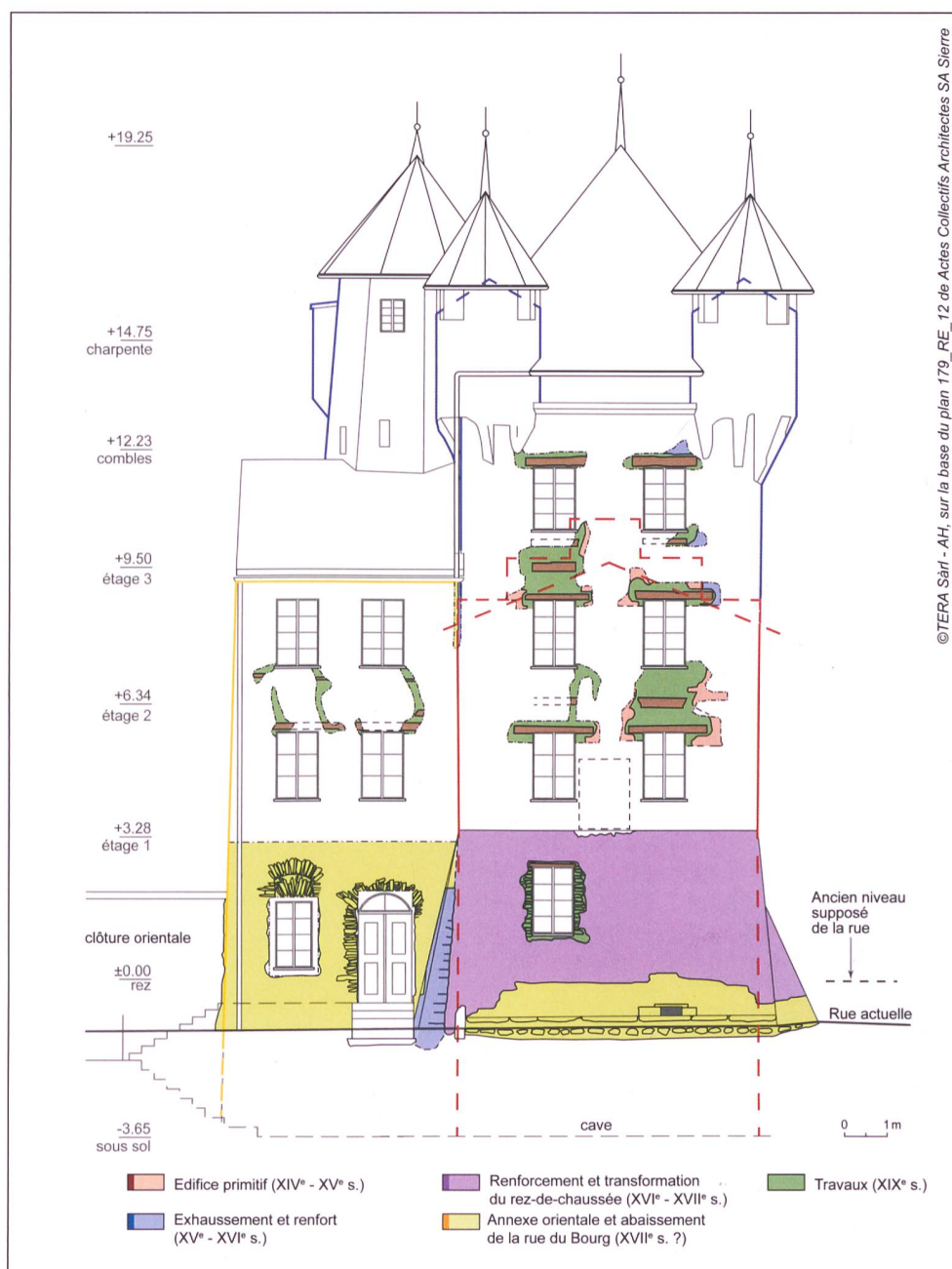
6: Sierre VS, tour des Vidomnes. Relevé archéologique de la façade nord.
