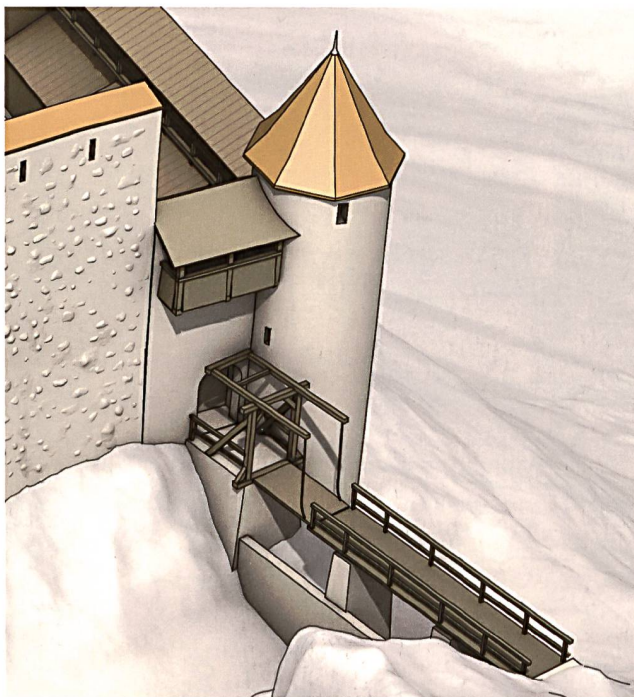
41: Pfeffingen BL. Rekonstruktionsversuch der Zugbrücke über den westlichen Burggraben. Blick von Nordwesten.
