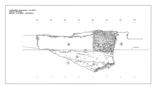
6: Lenzburg AG, Eisengasse. Westprofil Feld 5. Über der V-förmigen Spitzgrabensohle (1/2) liegen Einfüllschichten (3) aus der 2. Hälfte des 13. Jh. Im Zuge des Stadtmauerbaus (5) nach 1375 wurde in die Grabenverfüllung ein Arbeitsniveau eingetieft, von welchem aus das Fundament errichtet wurde. An diese wurde im 18. Jh. ein Keller (4) gebaut.
