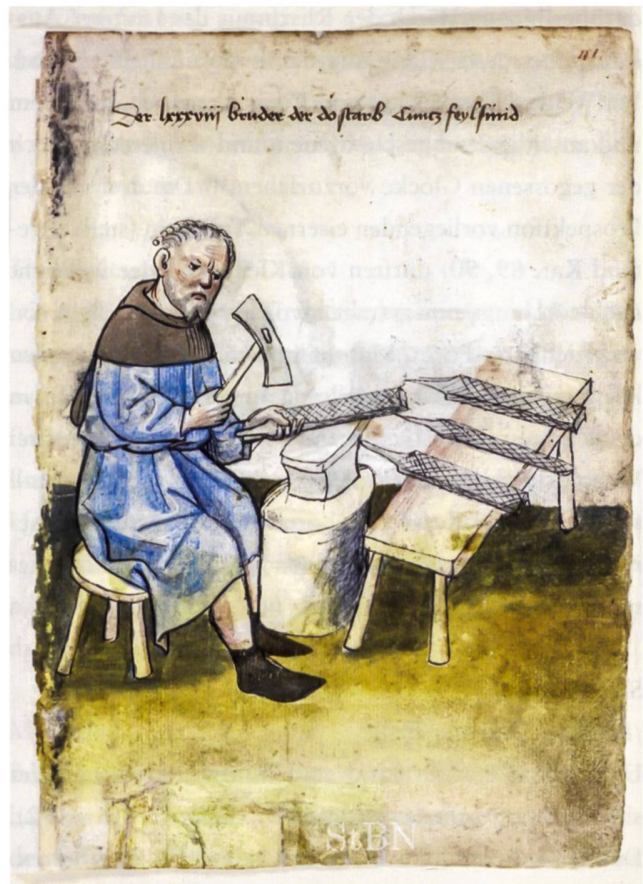
16: Der Feilenhauer «Bruder Cuntz» bei der Arbeit. Vor ihm auf der Bank liegen drei halbfertige Feilen noch ohne Griff. Hausbuch der Mendelschen Zwölfbrüderstiftung, Nürnberg, um 1425.
