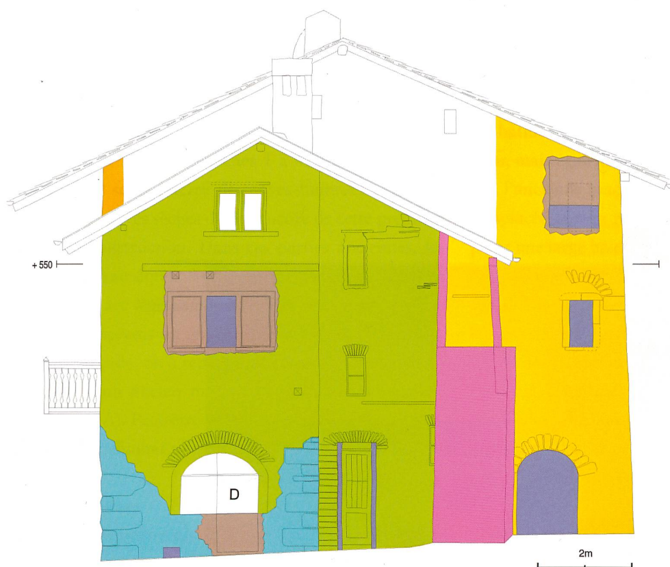
Planche 2: Maison Guerrati, relevé de la façade orientale. Légende des couleurs cf. planche 1 – Aufnahme der Ostfassade. Zur Farblegende vgl. Plan 1.
