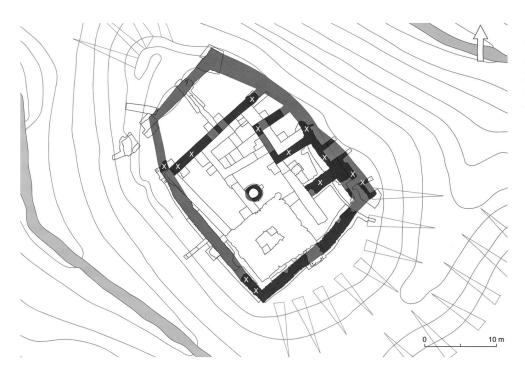
7: Ausgrabungsbefunde und rekonstruierter Grundriss der ersten Anlage. X = Mörteltyp MT3 nachgewiesen.
