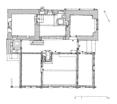
9: Köpli-Haus, Schwyz SZ. Der Grundriss des ersten Wohngeschosses zeigt die massiven turmartigen Bauteile in der hinteren Haushälfte. Dazwischen liegt die bis unter das Dach offene Küche.
