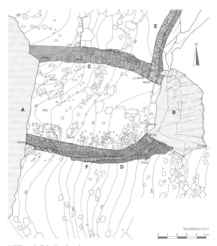
16: Val Bavona, Sott Piodau, Lüera. Gesamtplan. A, B: Sturzblöcke, C: Nordmauer, D: Südmauer, E: Grenzmauer, F: Durchgang.
