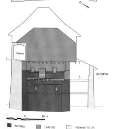
2: Am Wohnturm sind drei Hauptbauphasen ablesbar. Die Errichtung des Kernbaus, die Aufstockung und der Bau des Holzobergadens (1243[d]) sowie die Ummantelung mit dem Neubau des dritten Obergeschosses (mittleres 13. Jh.). Zeichnung: Werner Wild, Kantonsarchäologie Zürich.
