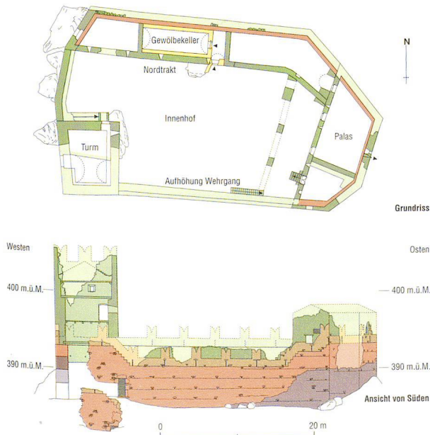
Tafel 1e: Grundriss und Ansicht Südfassade Phase 3.
