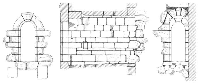
3: Dokumentation des Hocheingangs während der Untersuchungen Reinhold Boschs 1938. Innen- und Aussenansicht des Hocheingangs sowie nördliche Korridorwand, in welcher nahe der Tür die Aussparungen für den Sperrbalken sowie die Aufnahme des Türschlosses zu erkennen sind; Ms. 1:50.
