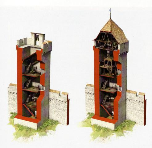
5: Blick in das Innere des Zytturms zur Bauzeit um 1403 (links) und nach dem Einbau des Uhrstuhls für das neue Uhrwerk um 1535 (rechts).
