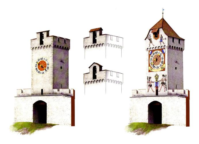
3: Rekonstruktion des Zytturms im Zustand der Bauzeit um 1403 (links, mit verschiedenen Dachvarianten für das Glockentürmchen) und 1535 (rechts, nach dem Umbau von 1508 und der Einrichtung einer neuen Uhr und eines neuen Zifferblatts 1535). Blick von Süden.
