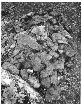
Abb. 7: Lajoux JU, Envers des Combes. Dichte, eisenhaltige Reinigungsschlacken.
