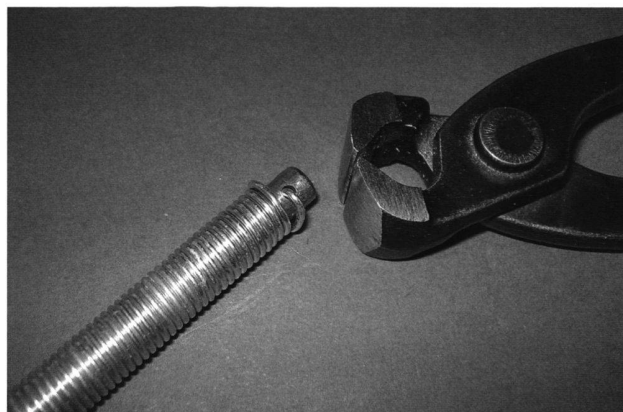
12: Sehle mit aufgerolltem Draht. Die einzelnen Windungen der Drahtspirale werden anschliessend mit der Kneifzange abgetrennt.
