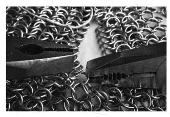
13: Die Ringe werden mit der Zange aufgebogen und nach dem Einhängen wieder zusammengebogen.
