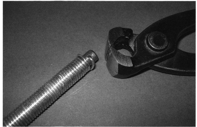
12: Sehle mit aufgerolltem Draht. Die einzelnen Windungen der Drahtspirale werden anschliessend mit der Kneifzange abgetrennt.
