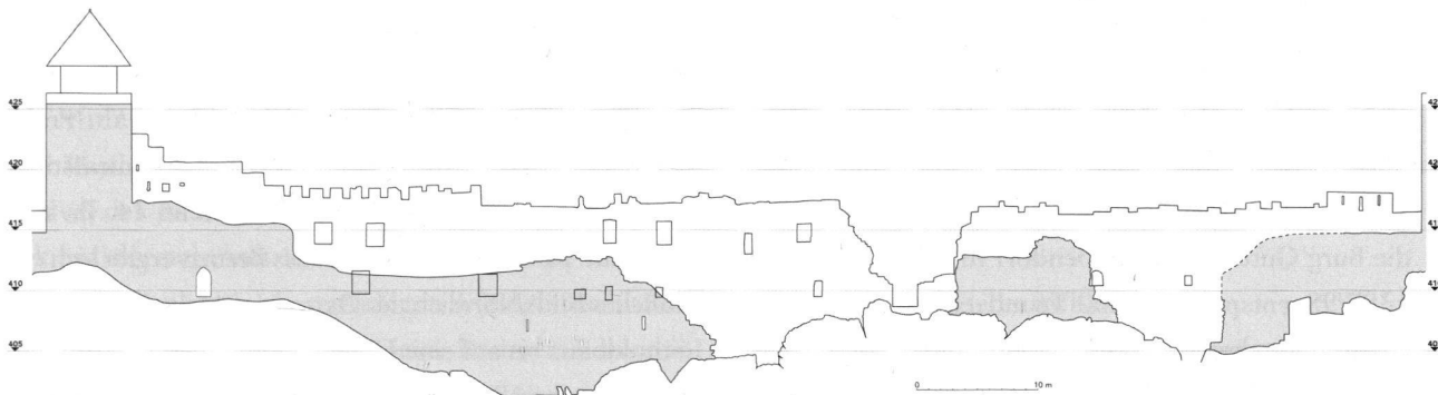
12: Arlesheim-Birseck, Bering und Turm. Kartierung der Mauerpartien des Lütholdbaus, die im Erdbeben von 1356 nicht eingestürzt sind oder danach nicht abgebrochen werden mussten (grau). Die weissen Mauerpartien entsprechen – zusammen mit dem Palas – ungefähr dem Bauvolumen, das anschliessend für 800 Gulden wieder aufgebaut wurde.
