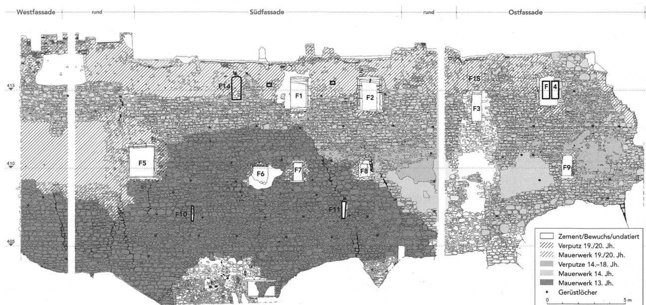
5: Arlesheim-Birseck, steingerechte Aufnahme der Süd- und Ostfassade mit Grobkartierung der Bauphasen. Die im originalen Mauerverband liegenden Fenster sowie die beiden Balkenlöcher des Erkers sind schwarz umrahmt.
