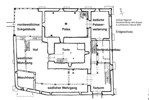
3: Grundriss des Erdgeschosses mit verschiedenen Gebäudeteilen.
