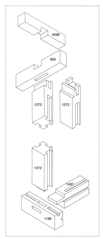
9: Details der Holzkonstruktionen (Ansichten nach Südosten): oben die Verbindung auf dem Fassadenständer (1272, in zwei Ansichten) mit dem Rähmbalken (969) auf der Nordfassade und dem rekonstruierten Rähmbalken (4098) auf der Kammerwand. Unten die Verzapfung des Fassadenständers (1272) und der Kammerwandschwelle (1487) in die nördliche Fassadenschwelle (1196).
