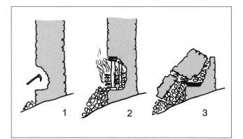
16: Vorgehen beim Mauerbrechen (schematische Darstellung aufgrund von Schriftquellen und archäologischen Befunden): 1 Untergrabung des Mauerfusses, 2 Verbrennen der Holzstützen, worauf die Mauer ihren Halt einbüsst, 3 Eingestürzte Mauer. Die schwarze Brandschicht liegt mitten im Schutt.
