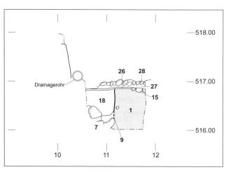
5: Profil 3 (zur Lage vgl. Abb. 4), Blick nach Norden. Das Innere der Kirche I befand sich rechts (Mörtelboden (15)). Über der Abbruchkrone der Westmauer (7) liegen Schutt (18) und das dünne Bauniveau der Kirche II (26). Deren Mörtelboden (28) befand sich auf einer Planie (27). Nicht dargestellt ist die darüberliegende Planie (42).
