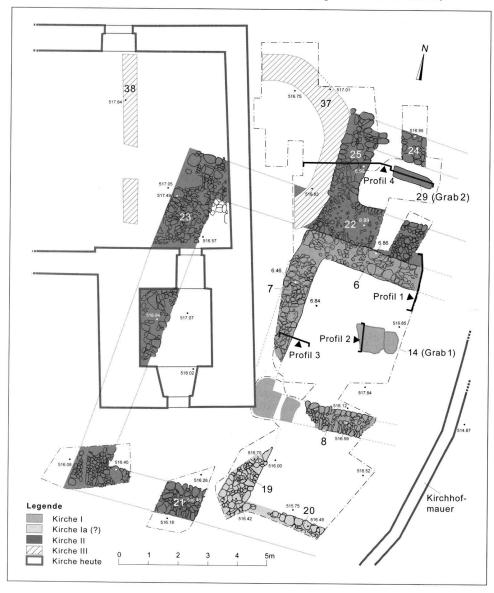
4: Bauphasenplan der Kirchen I-III. Die Höhenkoten dokumentieren die unterschiedlichen Abtiefungsniveaus. Während die Grabungen von 2003 konsequent bis auf den gewachsenen Boden erfolgten, endeten die Freilegungen von 1959 auf unterschiedlichem Niveau. Kirche I: 6, 7 und 8 Aussenmauern, 14 Grab 1; Kirche Ia (?): möglicherweise 19, 20 Aussenmauern; Kirche II: 20-23 Aussenmauern, 24, 25 Aussenmauern Anbau, 29 Grab 2; Kirche III: 37 Chormauer, 38 Binnenmauer. Der Abwasserkanal
