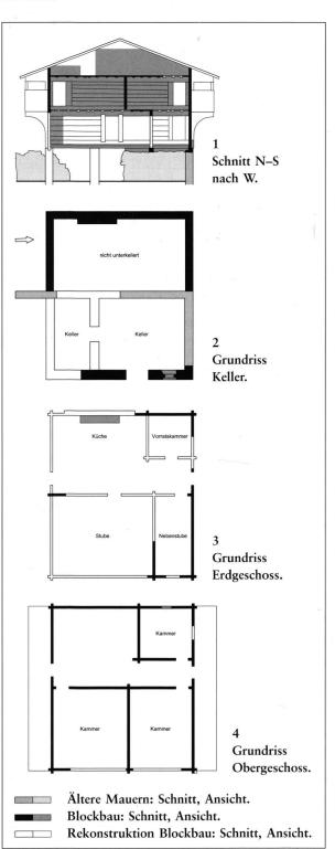
eine ursprünglich vorhandene Laube an der Nord- bzw. Südfassade. Aufgrund der westlichen Giebelfassade ist als Dachkonstruktion ein flach geneigtes Pfetten-Rafen-Dach anzunehmen.
