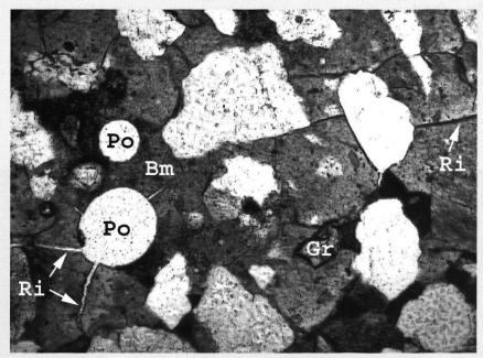
Wasserglasmörtel im Dünnschliff unter dem Mikroskop, im einfach polarisierten Durchlicht, Bildbreite ca. 2 mm. Im Bild sind die kugeligen Poren (Po) und Risse (Ri) im Wasserglas-Bindemittel (Bm) sowie ein Granatkorn (Gr) als Zuschlag sichtbar.
