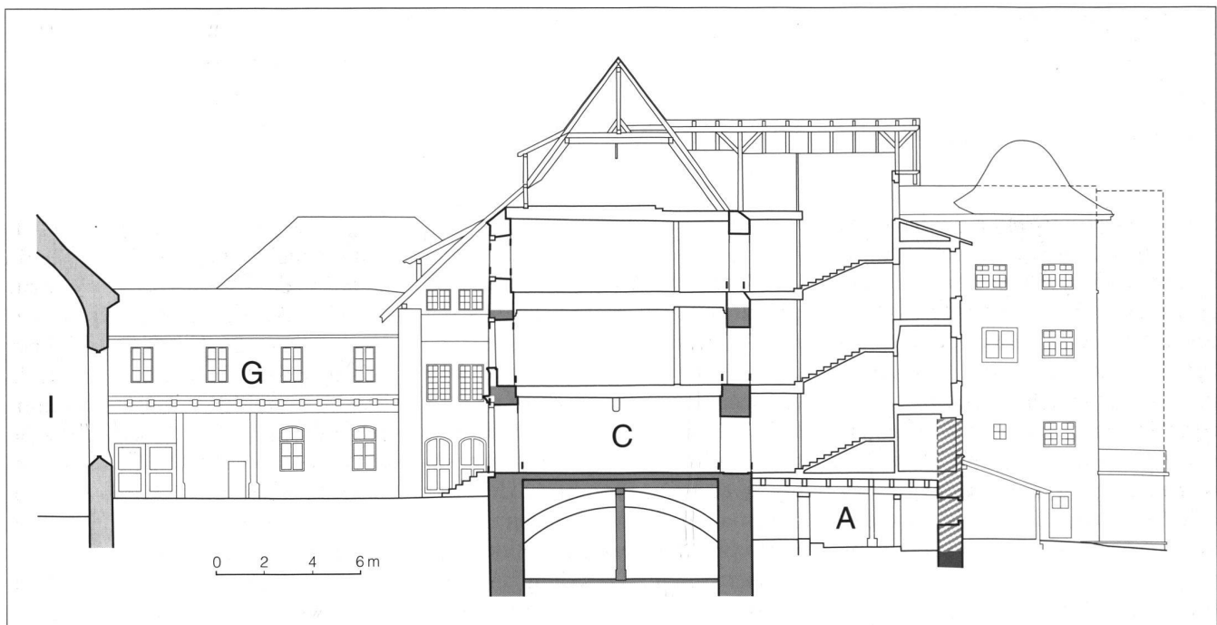
14: Querschnitt N-S durch das Steinhaus der Phase 1, das Saalgeschosshaus der Phase 2 und den Kirchenchor.
