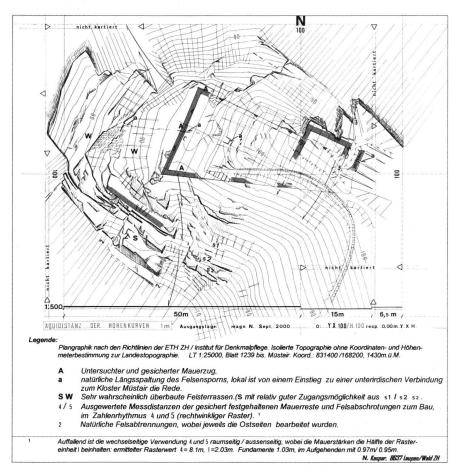
Müstair, Ruina Balcun At/Hohenbalken. Feldaufnahme im Massstab 1:500, Flächentopografie innert 4 Tagen, Vorarbeiten mit Geländebegehung 1 Tag, Umzeichnung zum Reinplan 3 Tage, Auswertung der Feldaufnahme mit den untersuchten archäologischen Bodeneingriffen 2 Tage.
