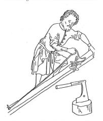
5: Zimmermann beim Einrichten eines Werkstückes mit der eingeschwärzten Schnur<sup>s</sup>.
