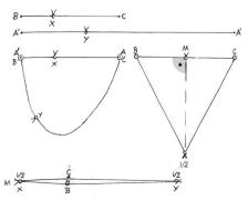
21: Spezielles Schnurgespann zum korrekten Ausspannen der Chorbreite.
