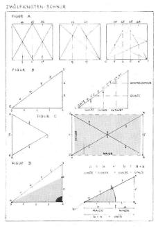
15: Anwendungsmöglichkeiten der Zwölfknotenschnur. Bei Figur C ist aufgezeigt, wie relativ nahe ein Rechteck, gehildet aus zwei gleichseitigen Dreiecken und jenem des goldenen Schnittes (gerastert) liegen.
