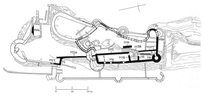
12: Grundriss Bauphase III. Legende vgl. Abb. 8. Der Hexenturm (T1) ist auf der Höhe des obersten Geschosses geschnitten, der Nordwesthau (M6, M6N, M15, M18) auf der Höhe des zweiten Geschosses.
