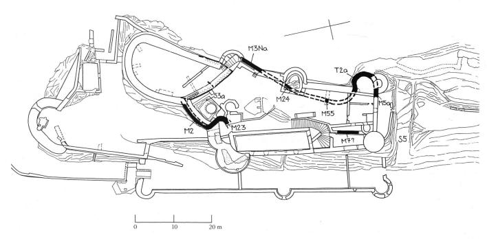
8: Grundriss Bauphase II. Schwarz: Neubauten. Gerastert: bestehendes Mauerwerk. Gestrichelt: rekonstruierte Mauerzüge.
