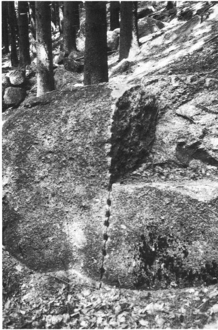
3: Bergalingen D. Ein mit Hilfe von regelmässig eingehauenen Löchern und darin eingesetzten Keilen teilweise gesprengter Stein.
