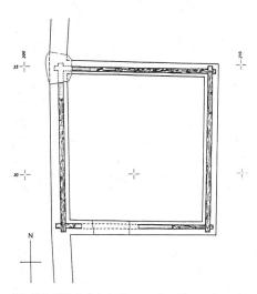
14: Brig VS, Salzhof. Maueranker. Konstruiert als geschlossener Rahmen aus vier in den Ecken überblatteten Balken.
