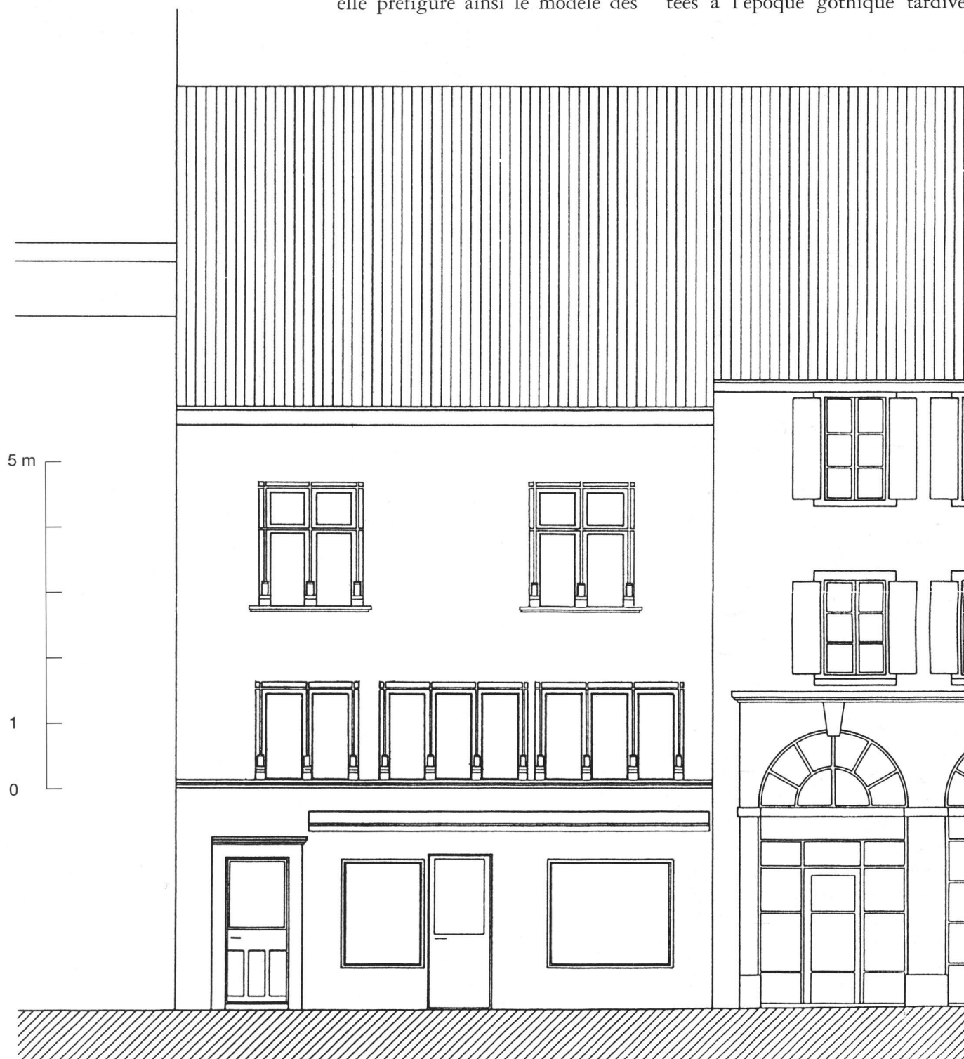
12: Yverdon – Rue du Collège 10. Restitution de l'état originel de la façade sur rue.
