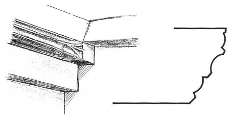
3: Lausanne – Rue de la Cité-Derrière 28. Détail de la mouluration de la poutre de rive de la camera.
