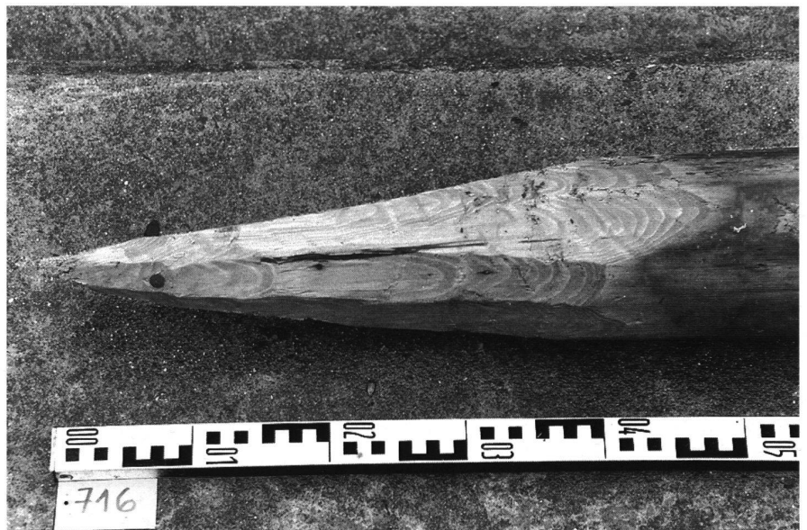
10: Pfahl Nr. 716, äussere Pfahlreihe «Waldstätterhof». Länge der Spitze 45 cm. Die Spitze wurde wohl mit dem Ziehmesser zugerichtet.
