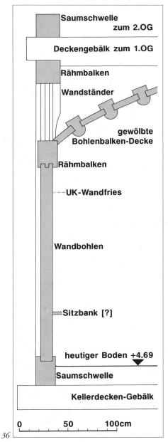
35: Palas D von 1451: Abbunddetail an der Westwand im 2. Obergeschoss, 1:50.
