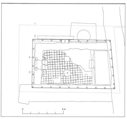
8: Grundriss des Schutzbaus. (1) Vorderkante Dachüberstand, (2) Glasfassade, (3) integrierte Vitrine, (4) Holzstütze, (5) Umfassungsmauer Burgkapelle, (6) Fliesenboden.
